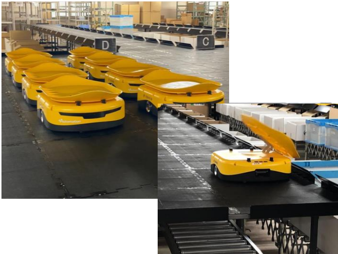
フルオートメーション AGV(無人搬送機)による仕分け
