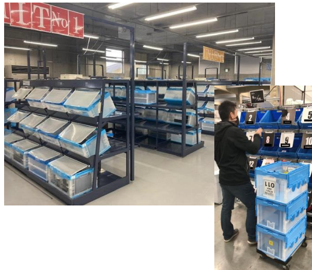
セミオートメーション GAS(ゲートアソートシステム)による仕分け
