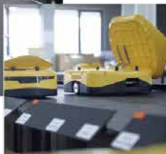
フルオートメーション AGV(無人搬送車)による仕分け
